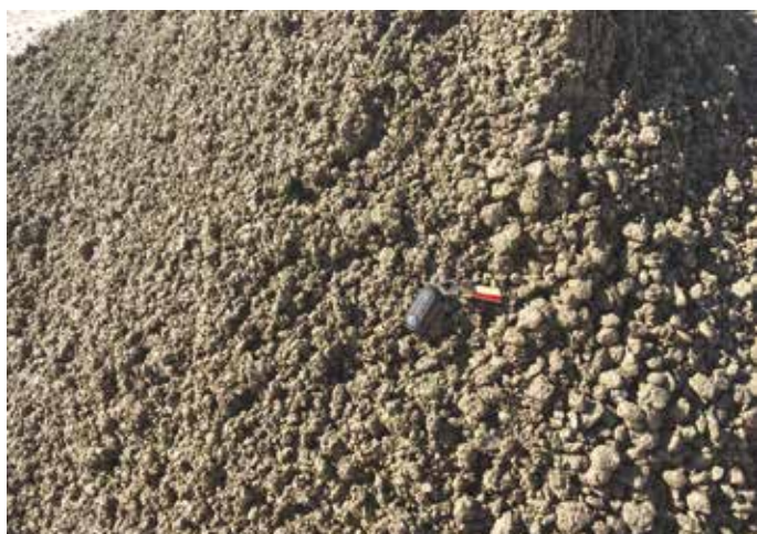
10. Dettaglio del misto cementato con matrice in conglomerato bituminoso di recupero 0/25
